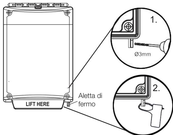
**Sostituzione della batteria (serie STI-13000 con segnalatore acustico)** - Per sostituire la batteria PP3 a 9 V nell'unità di allarme, inserire il perno di assistenza, rimuovere le due viti nella parte inferiore dell'unità di allarme e sostituire la batteria. Per il riassetto, assicurarsi di rimuovere il perno di assistenza. Conservare sempre il perno.
