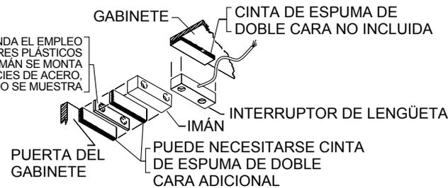
CLIP DE ACTIVACIÓN KIT-131 A LA CARCASA DEL MINI THEFT STOPPER (ANTIRROBO).
